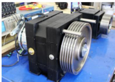
Serie CUBO di motori sincroni a magneti permanenti sviluppata da MSM per l'applicazione sugli ascensori. Portate da 300 kg a 2000kg e velocità fino a 2,5 m/s.
