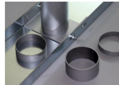
Semplice ma efficace: serie di anelli inseriti sul supporto ammortizzatore che rendono semplice e rapida la compensazione dell'allungamento funi dopo il primo periodo di funzionamento.
