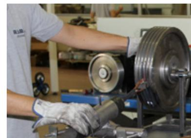
L'operazione di tempra delle gole delle pulegge di trazione riduce drasticamente l'usura e garantisce alle pulegge una durata pari a quella dell'impianto.
